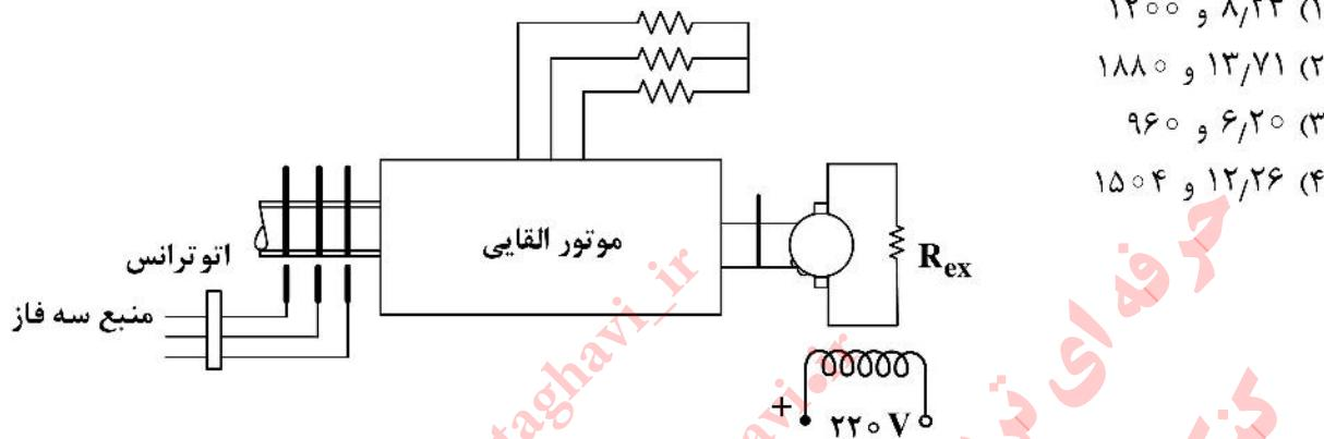
۷۷- یک ماشین جریان مستقیم تحریک مستقل به یک ماشین القایی سه فاز  $50\text{ Hz}$ ،  $50\text{ Hz}$  و ۴ قطب مطابق شکل زیر کوپل شده است. ماشین جریان مستقیم برق دار شده و ماشین‌ها با سرعت  $1600\text{ rpm}$  می‌چرخد. در این حال ماشین القایی نیز به یک منبع سه فاز  $50\text{ Hz}$  وصل شده و همانطور می‌چرخد. در حالت ماندگار:
